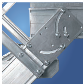
Conexión escalera-pedestal para inclinaciones de 45° a 70°
