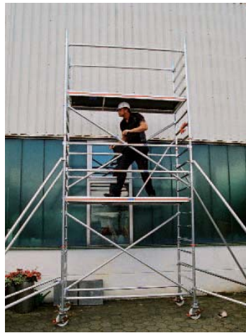
Dadurch ist ein Aufstieg auf die Plattform schon mit Seitengeländer möglich.
