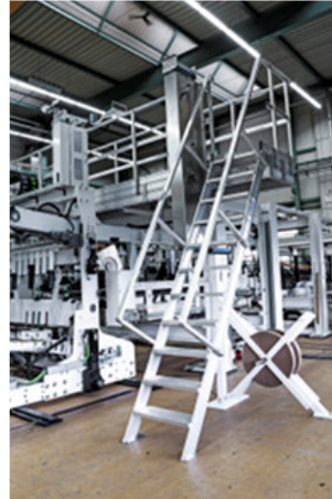
Wartungsbühne für Instandhaltungsarbeiten an einer Verpackungsmaschine: Hymer-Leichtmetallbau lieferte für die spezifischen Anforderungen des Kunden einen Überstieg mit beidseitigen Treppenaufgängen.
