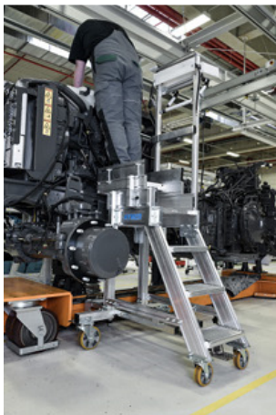
Für einen Traktorenhersteller konstruierten die Hymer-Experten für Sonderkonstruktionen teleskopierbare Aluminiumritte, die mittels Magnetanbindung an der Fertigungsstraße mitgeführt werden.
