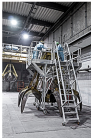
Zweiteilige Arbeitsbühne von Hymer-Leichtmetallbau zur Wartung der Müllgreifer für eine Müllverbrennungsanlage.
