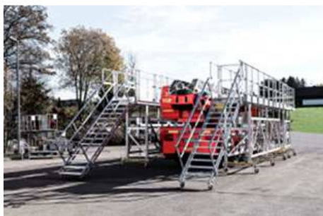
Konstruktion für die Montage von Dachaufbauten: Jedes Element der frei kombinierbaren 5-teiligen Bühne ist per Kurbelmechanismus separat höhenverstellbar.
