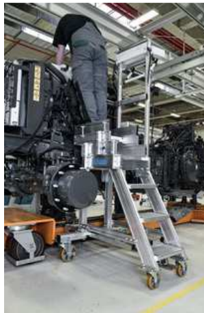
Für einen Traktorenhersteller konstruierten die Hymer-Experten für kundenspezifische Lösungen teleskopierbare Aluminiumtritte.
