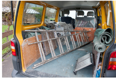
Safety first: Arbeitsmaterial ungesichert auf der Laderampe zu transportieren kann zu Beschädigungen an Leitern, Gerüsten oder Werkzeug führen und im schlimmsten Fall einen Verkehrsunfall verursachen.
